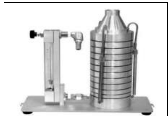
図9. アンダーセンノンバーブルサンプラー (東京ダイレック(株)製・AN-200型)
